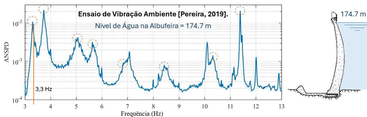
Figura 2.4 – Ensaio de vibração ambiente realizado em 12 de junho de 2018 (Pereira, 2019). a) Localização dos acelerómetros; b) Densidade Espectral de Potência Normalizada Média (média dos nove acelerómetros) para identificação das frequências dos principais picos espectrais (correspondentes a frequências naturais)
