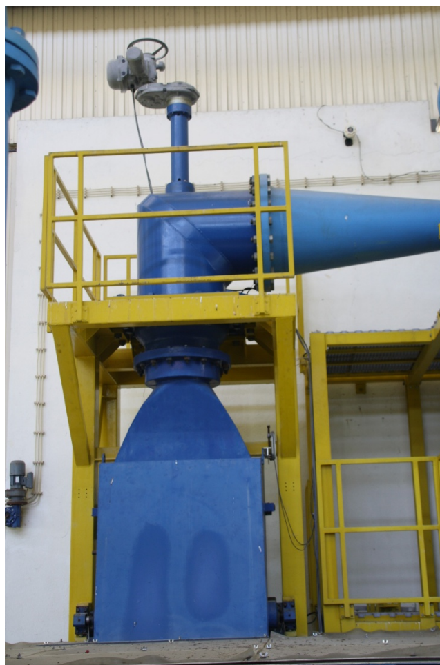
Figura 2.17 – Defletor associado ao sistema de pesagem 2
