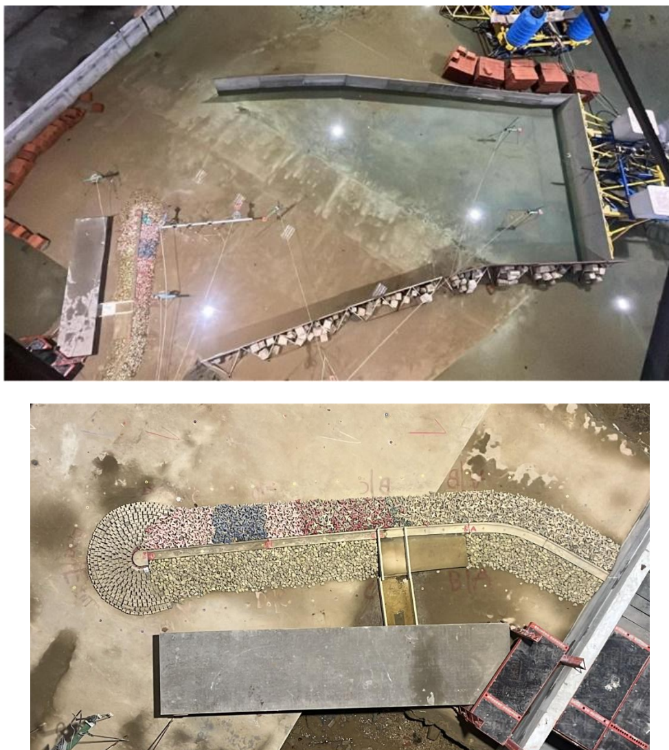
Figura 1.5 – Vista geral do tanque de ondas irregulares e do modelo físico do quebra-mar
