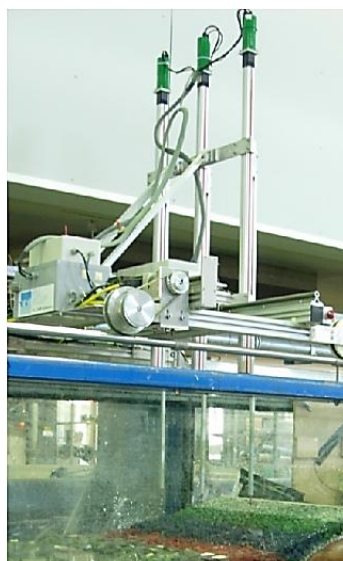
Figura 1.2 – Perfilador mecânico automatizado (Hofland, 2011)
