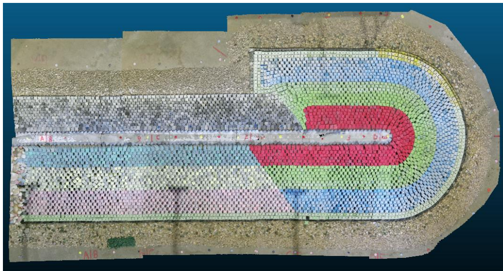
Figura 4.3 – Nuvem de pontos do modelo físico da aplicação do molhe leste do porto de Sines
