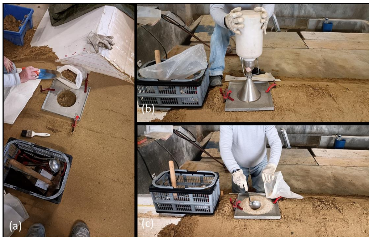
Figura 3.16 - Ensaio da garrafa de areia. (a) Remoção da amostra. (b) Preenchimento com material calibrado. (c) Remoção do material calibrado.
