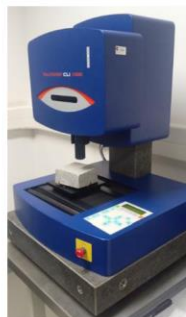
Figura 1 – Perfílmetro óptico da UMA (marca Taylor Hobson, modelo Talysurf CLI 1000)
